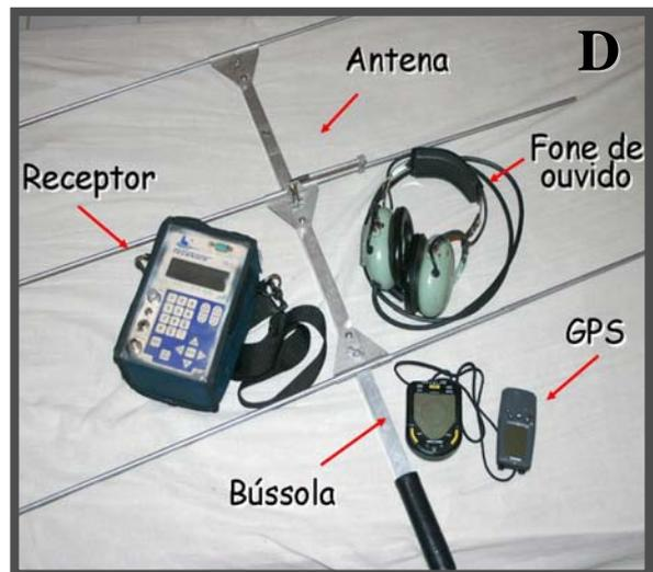
**Figura 4** - Animais equipados com rádio-colares no Pantanal da Nhecolândia (MS) e equipamentos de radiotelemetria VHF utilizados para monitorá-los entre fevereiro e outubro de 2005. (A) *Leopardus pardalis*; (B) *Nasua nasua*; (C) *Cerdocyon thous* e (D) Aparelhos de radiotelemetria. Fotos: Fabiana L. Rocha.
