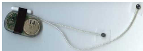
Sändare med två elektroder. På bilden är en vit magnet fastsatt för att inaktivera sändaren då den är utplockad.
